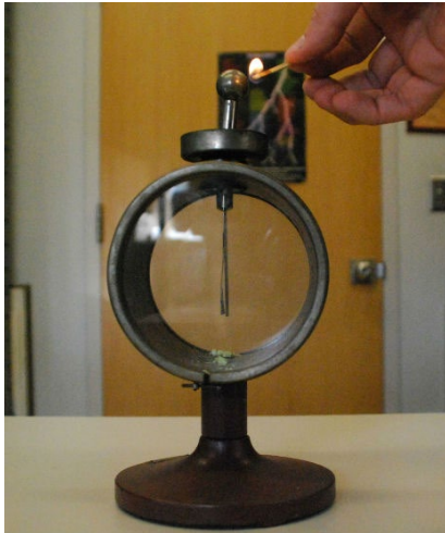
figuur 7: het ontladen van een elektroscop met een lucifer.
