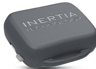
Fig. 1. ProMove-mini IMU node
