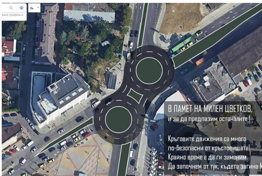
Figure 14. Proposed 8-shaped roundabout. Source: Nikova (2020), Арх. Игнатов предлага кръгово пред "Парадайс" в памет на Милен Цветков (СНИМКИ). Retrieved May 26, 2024, from https://stolica.bg/mestna-politika/arh-ignatov-predlaga-kragovo-pred-paradais-v-pamet-na-milen-tsvetkov-snimki .
