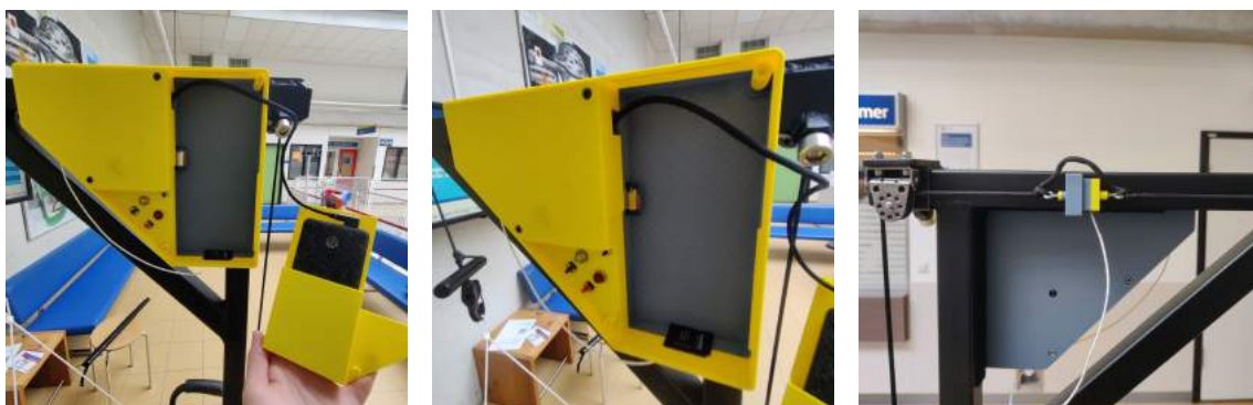
(a) Volledige hardware omhulsel met bovendeksel losgemaakt.
