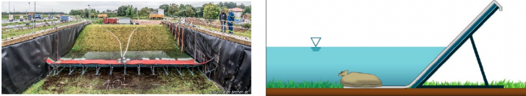
Figuur 28: Draagbare opklapbare noodmaatregel foto (links) en schematische weergave (rechts) [Masolle et al., 2018].
