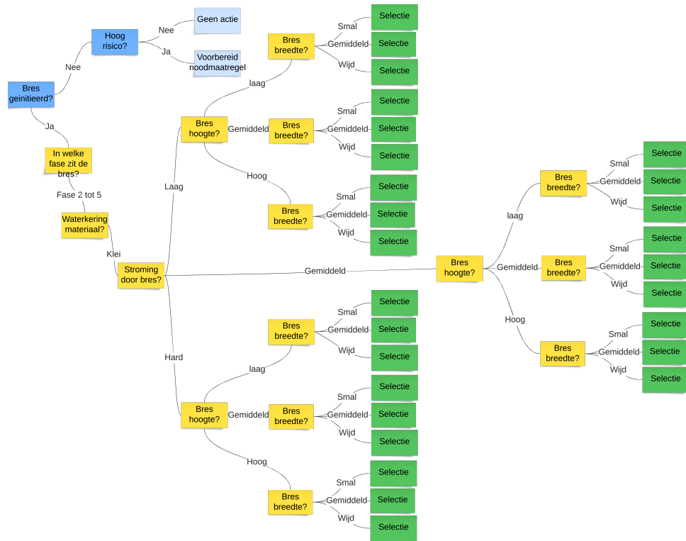
Figuur 41: Handelingsperspectief resultaat deel 1.3 beslisboom klei-waterkering.
