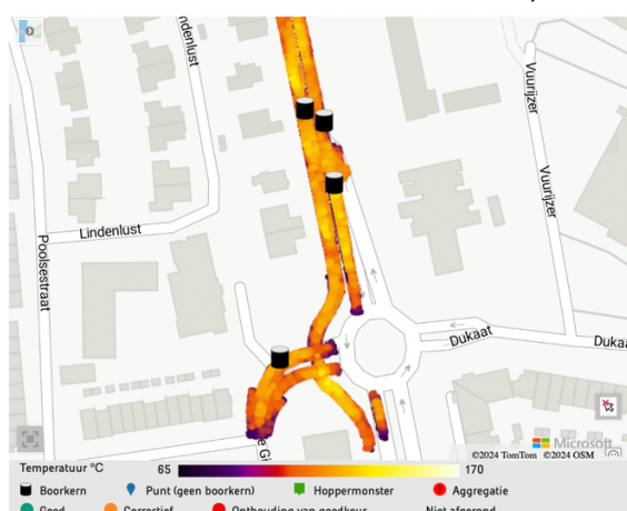
Figuur 20: Temperature Contour Plot (TCP) van de eerste wals overgang.
