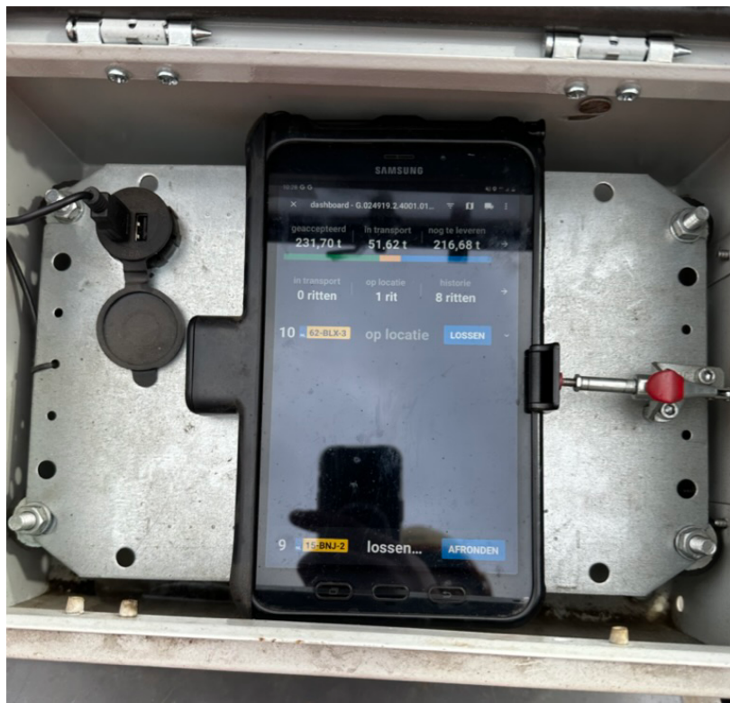
Figuur 11: De tablet zoals achter op de spreidmachine in een beschermende box.
