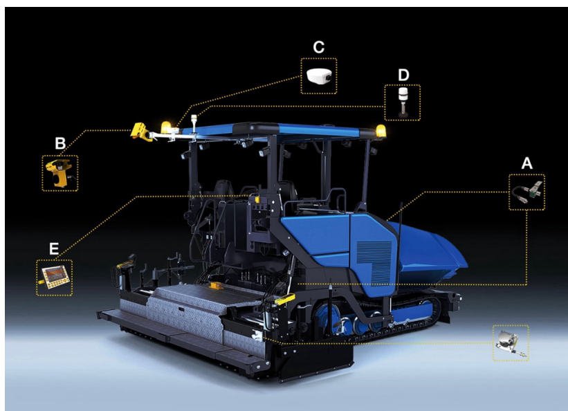
Figuur 6: Voorbeeld van een asfalt spreidmachine, de letters A-E verwijzen naar de bijbehorende apparatuur zoals genoemd in de tekst. (MOBA, z.d.)
