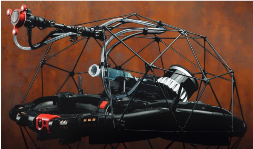
Figuur 13: Drone uitgerust met ultrasone lading (Flyability, 2022c)
