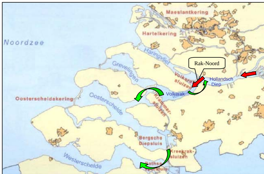
Figuur 1.5: De maatregel berging op het Volkerak-Zoommeer. De rode pijlen geven de richting van waterberging aan, de groene pijlen de doorvoer routes [aangepast van 15].
