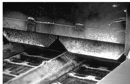
Figuur 3: Uitstroomgaten waarmee de hoeveelheid getransporteerd asfalt kan worden geregeld
