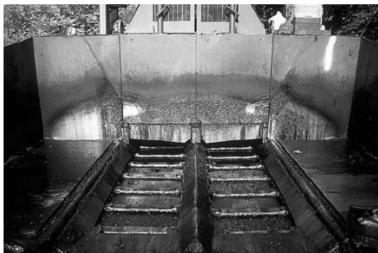
Figuur 2: Horizontale transportbanden die asfalt van hopper naar balk transporteert
