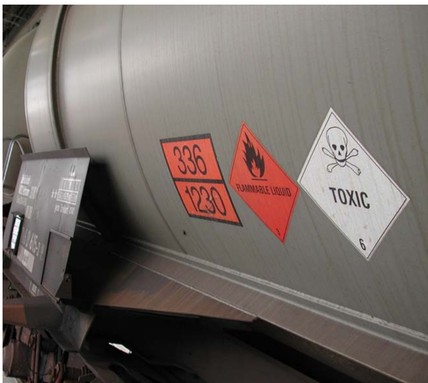
Stofnummer en gevarenetiket op ketelwagen
