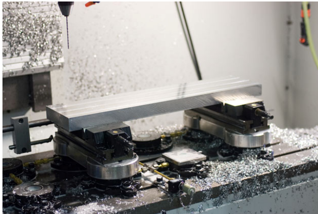
Figuur 15.1 Het massieve blok aluminium (linksboven), het aluminium tijdens de freesbewerking (linksonder), de middenbrug in de trommelmachine (rechtsboven) en de middenbrug wanneer deze getrommeld is (rechtsonder)
