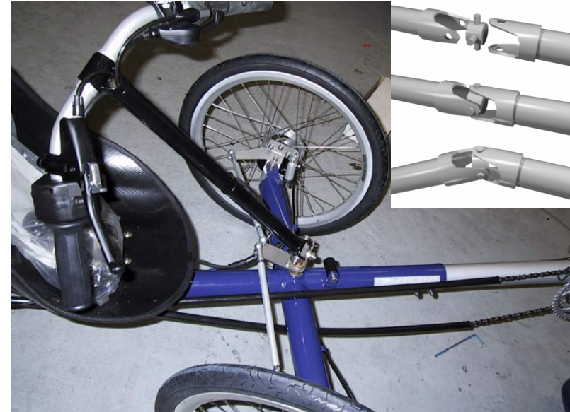
Figuur 11.1.1 Kruiskoppeling met in detail het technisch principe (rechtsboven)
