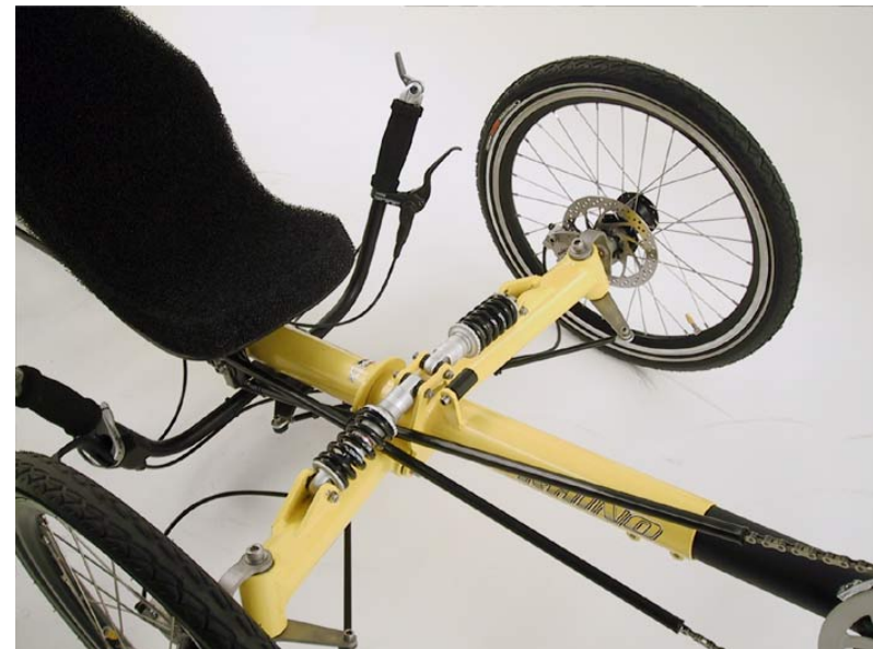
Figuur 11.3.2 Onderstuur dat onder het frame loopt
