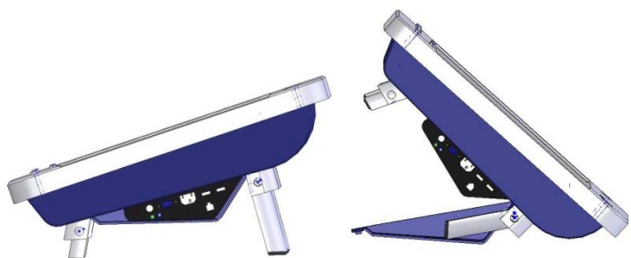
Figuur 54 Werking scharnierend mechanisme
