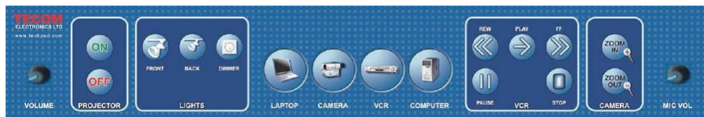
Figuur 11 Touchpanel van ILS18P, voor verandering omgevingsvariabelen, bediening VCR en switchen apparatuur.
