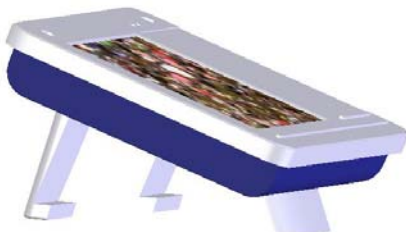
Figuur 48 Zijanzicht pootjes E (hogere dunnere versie van D poten)
