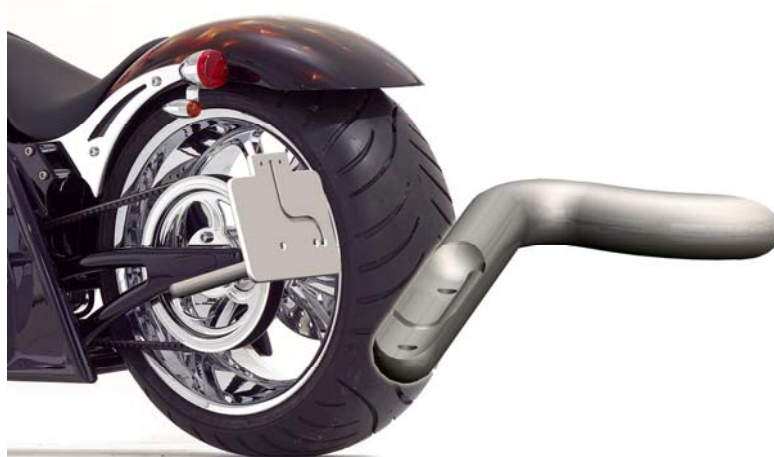
Een impressie van de uiteindelijke side mount gebaseerd op het laatste 'frees' ontwerp
