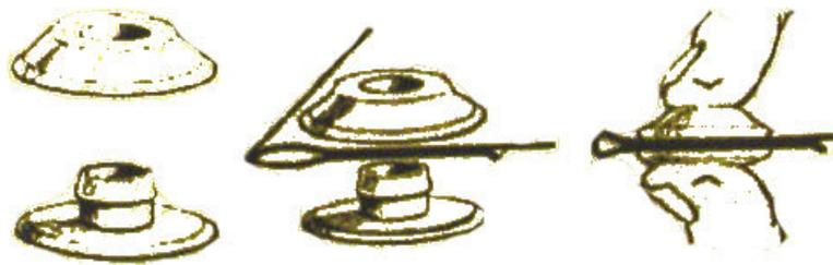
Fig. 55: Een zeilring en de bevestiging. Door meer ruimte over te laten tussen de twee helften wordt de beweegbaarheid van de tussenliggende laag vergroot [10].
