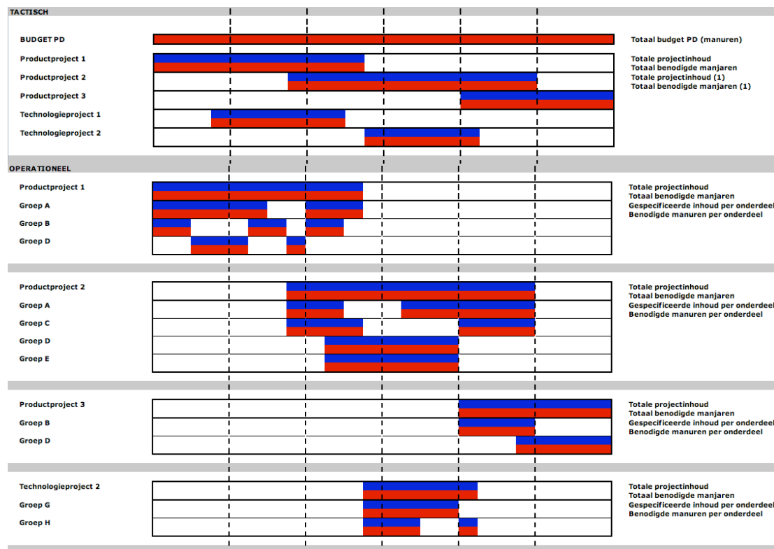
Figuur 7.3: individuele projectplanningen, waarin activiteiten (projectinhoud) en benodigde resources per constructiegroep zijn uitgezet in de tijd, tellen op tot een totaaloverzicht van projectbehoeften ter ondersteuning van resourceverdeling op tactisch planningsniveau.
