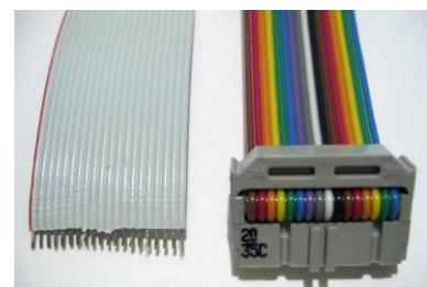
Figuur 5.6: Voorbeelden van platte lintkabels.
