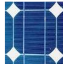
Figuur 5.1: Een monokristallijn silicium zonnecel.
