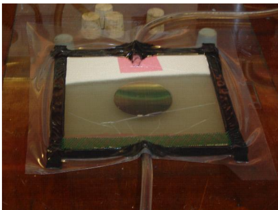
Figuur L.3: Foto's van het proefstuk tijdens en na het eerste lamineerexperiment.
