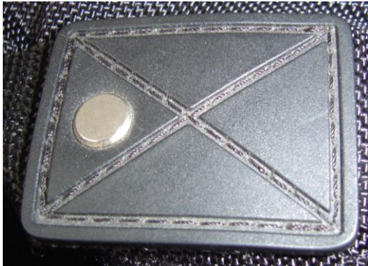
Figuur K.1: Vasthechting van rubberen plaatje aan stof van een rugzak.
