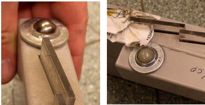
Afbeelding 32. De linkerkogel is van kunststof en zit aan het begin van de arm. De andere is een metalen en zit aan het uiteinde.
