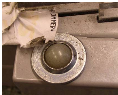
Afbeelding 53. De kunststoffen kogel is vies. Ook op de onderkant van de arm zit vuil.
