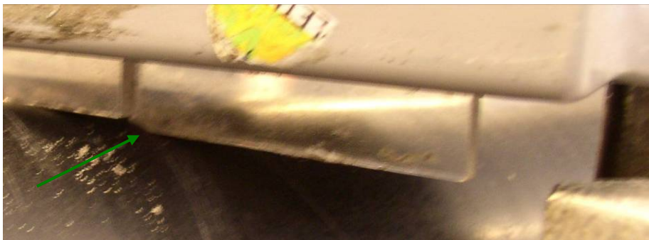
Afbeelding 73. De laatste lamel van de arm heeft nagenoeg geen werking.
