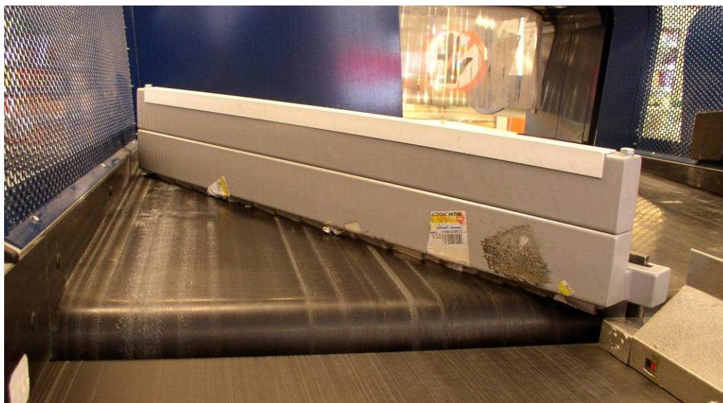
Afbeelding 30. De goederenscheider v2.0 band. Zichtbaar zijn de slijtage strepen van de band, de stickers op de arm. De witte strip is de stootstrip van de arm.
