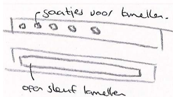
Afbeelding 78. Omdraaien van het bovenprofiel geeft geen gewenst resultaat.
