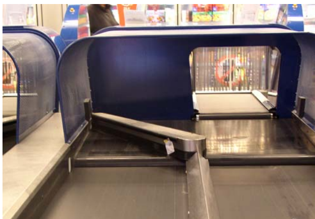
Afbeelding 36. Het SPL met de goederenscheider v1.0.
