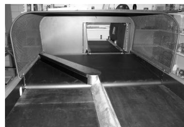
Afbeelding 5. Zicht op de goederenscheider vanaf de achterkant van het SPL
