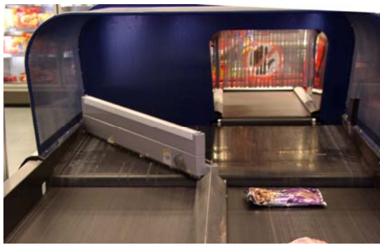
Afbeelding 61. Het SPL met de goederenscheider v2.0.
