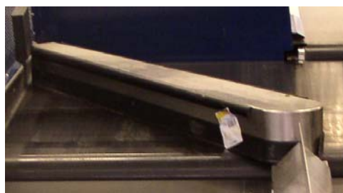
Afbeelding 64. De goederenscheider v1.0 met bijpassende stootrubbers.
