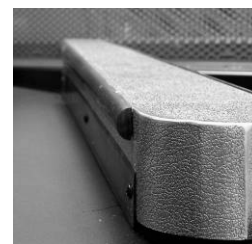
Afbeelding 1. Het rubber van een nieuwe goederenscheider staat recht naar beneden ipv schuin naar buiten.
