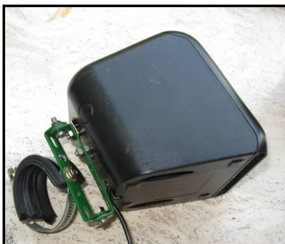
Figuur 8&9: satelliet speaker met bevestiging voor aan het stuur
