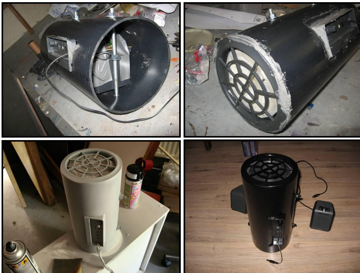
Figuur 55-58: van pvc buis tot werkende subwoofer met accu versterker en speakers
