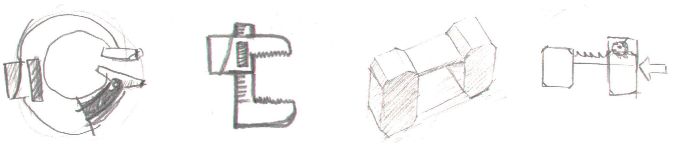
Figuur 23 - Een schroefklem in diverse vormen, met beveiliging tegen terugschieten.
