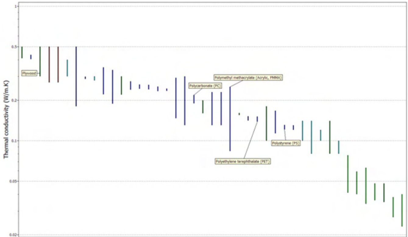
figuur 10 - Grafiek thermische conductiviteit materialen
