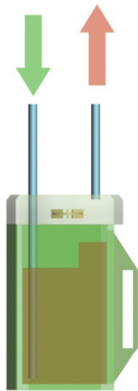
Fig 27 De in- en uitgaande slang van een buitenfilter
