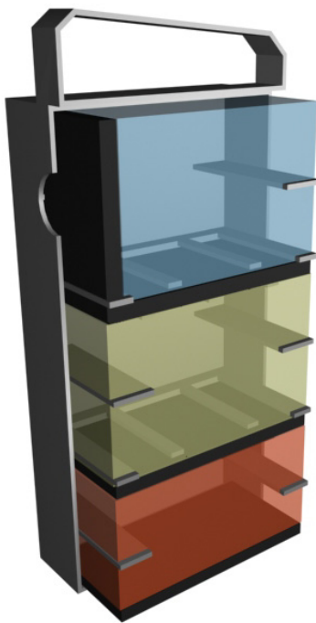
Fig 47 De gevulde cartridge waarbij een helft is weggelaten, de filterstoffen zijn te zien, evenals de zwartgekleurde scheidingslagen.
