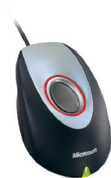
Afbeelding 31: Microsoft ontwikkelde een muis, waarmee de pc wordt vergrendeld zolang de juiste persoon zijn vinger niet op het scanoppervlak gelegd heeft.
