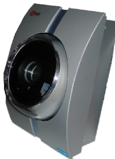
Afbeelding 12: De retina-scanner hangt bij de ingang van een gebouw of deur en scant het netvlies van het menselijk oog om tot een identificatie te komen.
