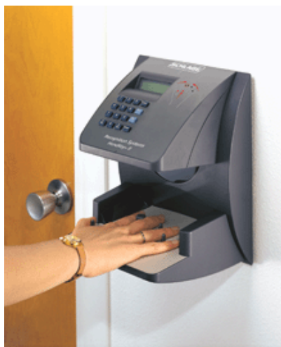
Afbeelding 14: Het Schlage Handkey-systeem: toegangscontrole door middel van een handafdruk-scan
