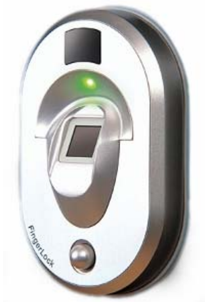
Afbeelding 13: Het FingerLock-systeem maakt een scan van het vingerooppervlak om mensen te identificeren.
