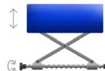
Figuur 5.17: Lendensteun met draadspindel en scharconstructie
