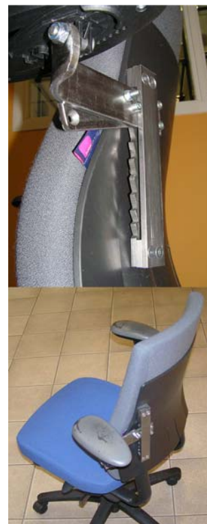
Figuur 5.32: Prototype met de armlegger aan de rugleuning
