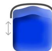
Figuur 5.35: De zitting schuift in de rugkap
