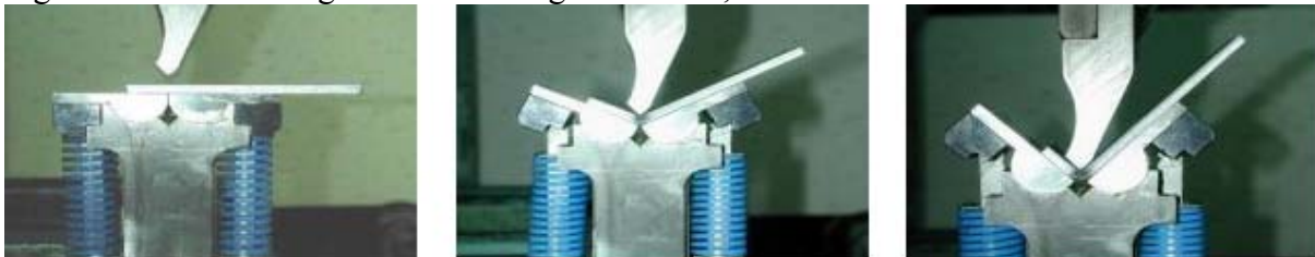
Figuur 1: visuele weergave van werking kantelblok, bron website FDP
