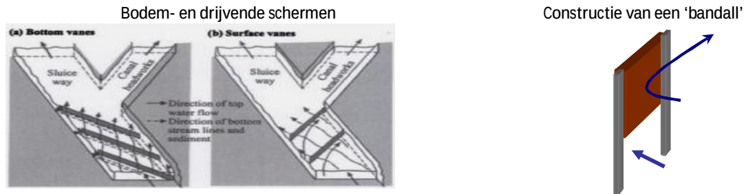
figuur 40: (links) een schematisatie van bodem- en drijvende schermen waarmee sedimentrijk water op de bodem van een aftakking (nevengeul) weg kan worden geleid door middel van spiraalstroming. (rechts) een schematisatie van een 'bandall' constructie waarmee ook sedimentarm water naar de nevengeul en sedimentrijk water naar de hoofdgeul kan worden geleid, wanneer deze bij de instroomopening van de nevengeul (kribvak) worden geplaatst.
