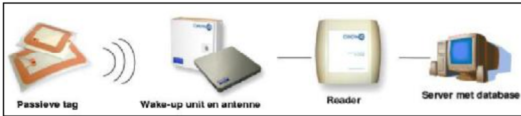
Fig. 3.3 Werking RFID technologie
