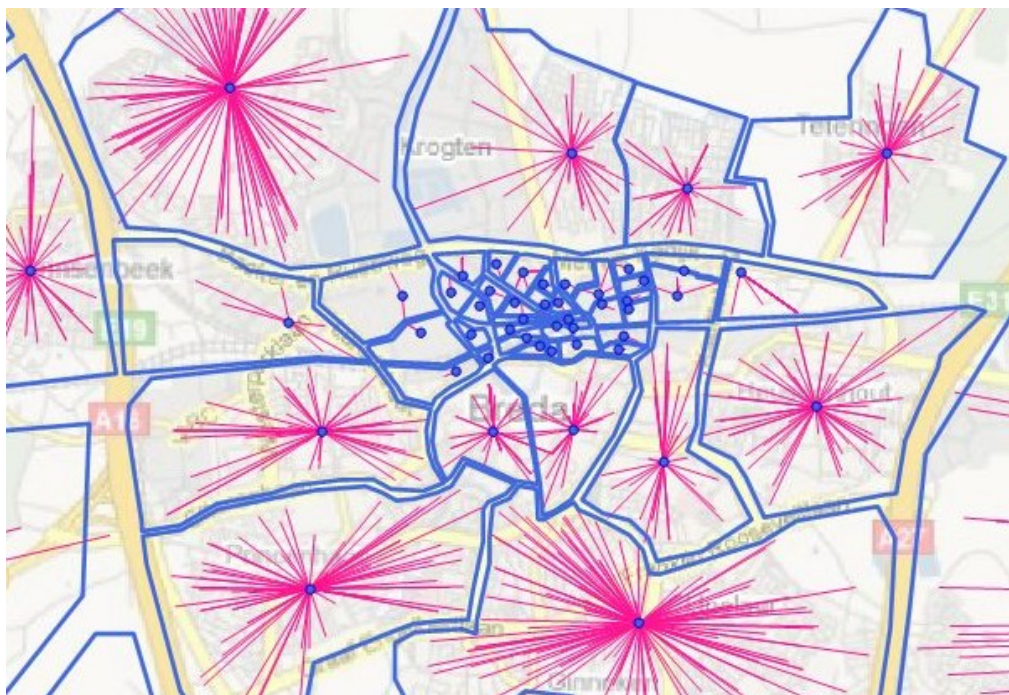
Figuur 79 – Visualisatie van de zoneconnectoren rondom Breda (blauwe punten zijn de zones, de roze lijnen zijn de connectoren die vanaf het (niet zichtbare) netwerk naar de zone lopen)
