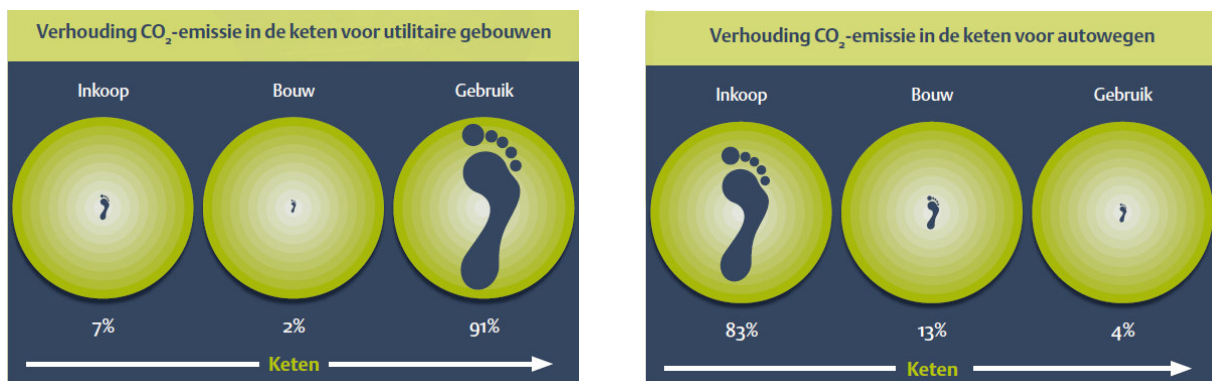
Figuur 6: Verhouding CO 2 emissie in de keten voor utilitaire gebouwen (links) en autowegen (rechts) (BAM, 2008)
