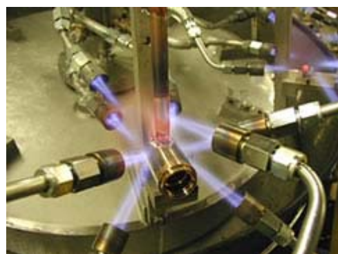
Figuur 4-3 Close-up van een soldeer machine. Het product wordt in een mal gestopt en vervolgens verhit om samen te vloeien met een verbindingsmetaal bijvoorbeeld zilver.
