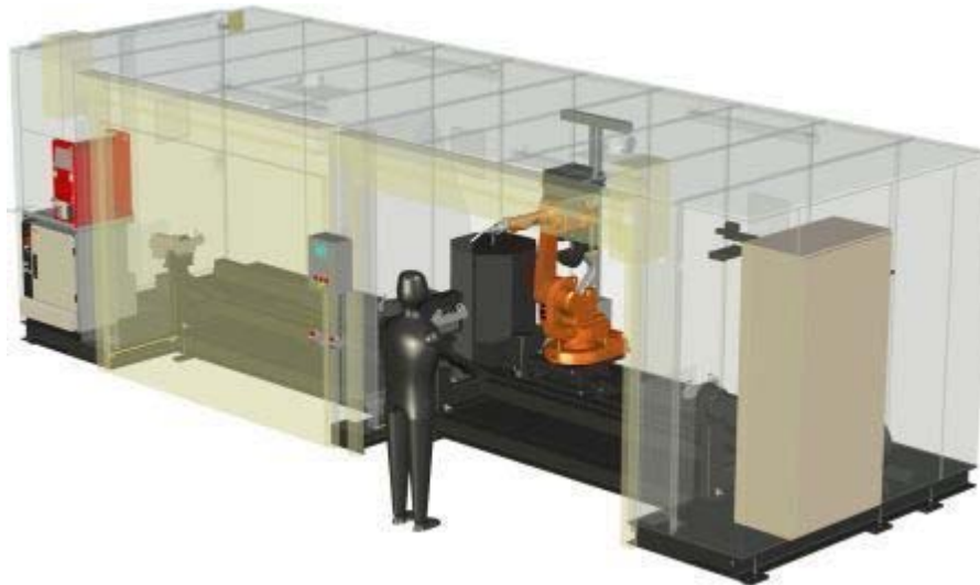
Figuur 4-2 Computer Illustratie van een robot cel. Op de lasafdeling zijn de robots uitgerust met meer inbouw plekken dan op de illustratie te zien is. Meestal 4 plekken.
