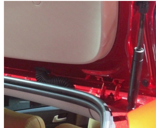
Figuur 37: Scharnier gemonteerd "op" het dak
