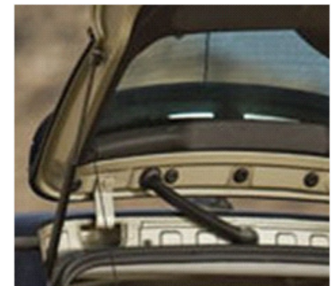
Figuur 38: Scharnier aan achterzijde dak
