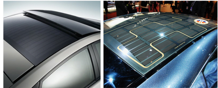
Figuur 63: Zonnepanelen geïntegreerd in het dak
