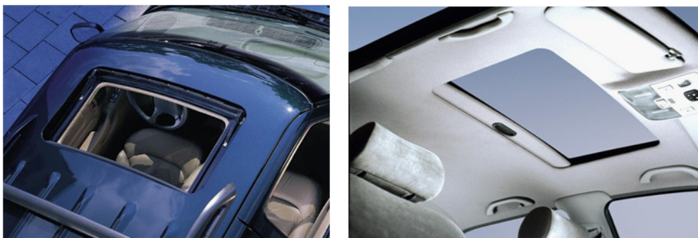
Figuur 57: Ingebouwd daksysteem (in het dak schuivend)
