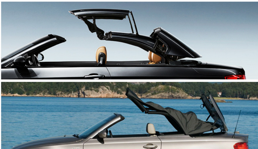
Figuur 64: Cabrio, hardtop (boven) en softtop (onder)
