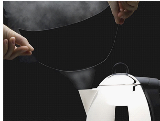
Figuur 48: Hydrophilic coating op Plexiglas stoot stoom af
