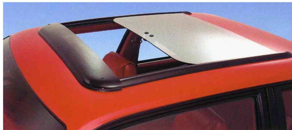
Figuur 59: Top mounted daksysteem
