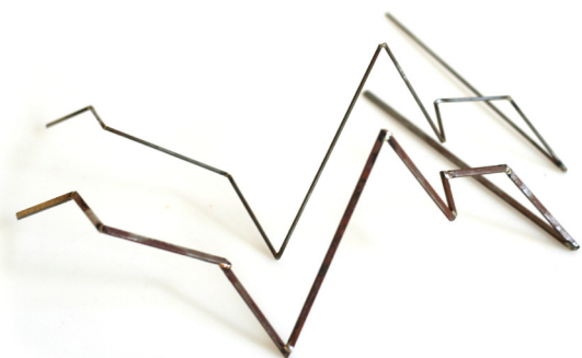
Figuur 31: Takken met een rond- (boven) en een rechthoekig profiel (onder)
