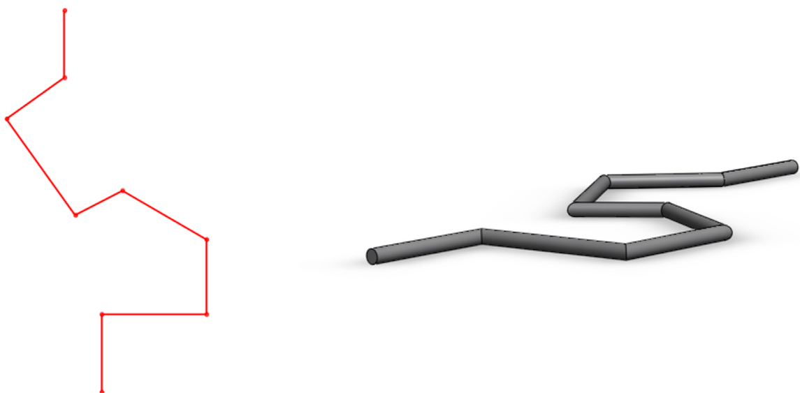
Figuur 32: De eenvoudigste manier om draad te buigen. Links: de vorm in een vlak, rechts: de gebogen draad
