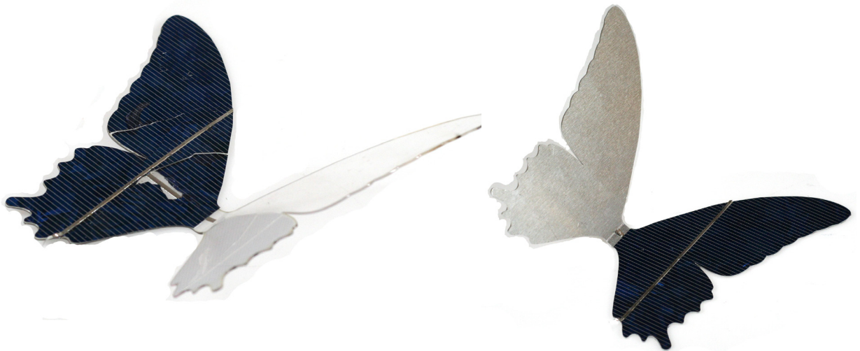
Figuur 63 Gebroken zonnecel op de PET drager (links) en een zonnecel op de aluminiumdrager (rechts)
