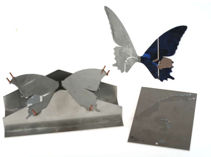
Figuur 98: De mal en de sandwich na de mislukte proef
