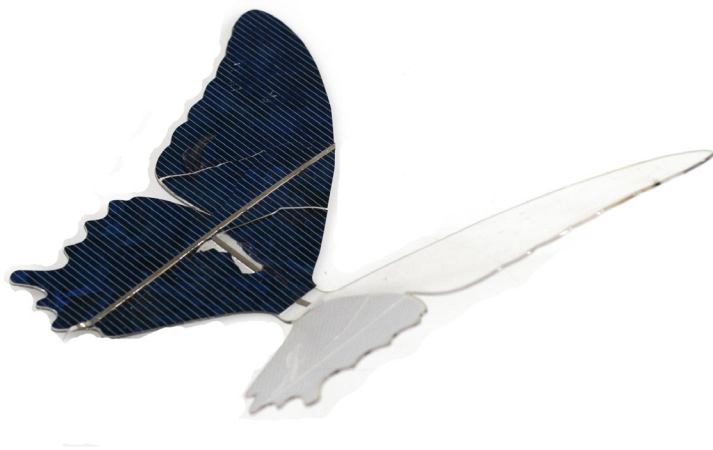
Figuur 11: Gebroken zonnecel op PET drager
