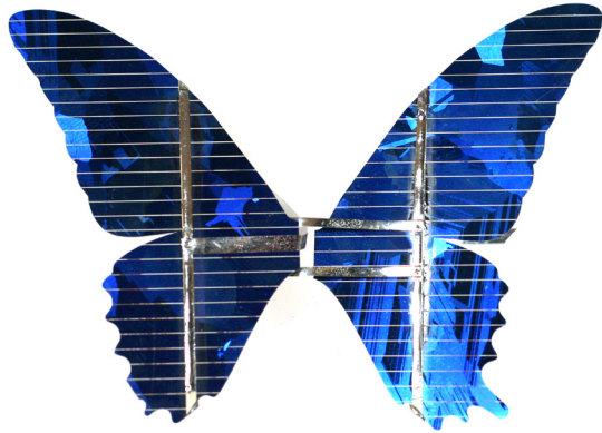
Figuur 65: De tapdraad is over de zonnecel heen gesoldeerd
