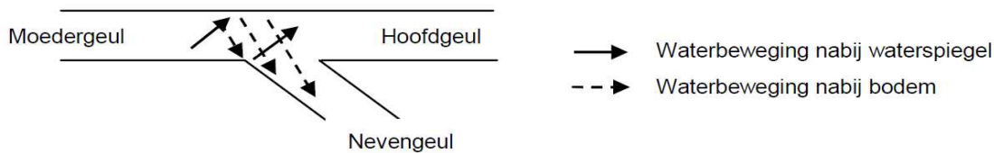
Afbeelding 6: Het Bulle-effect: sedimentrijk water op de bodem stroomt richting de nevengeul, uit Van der Mark (2004)
