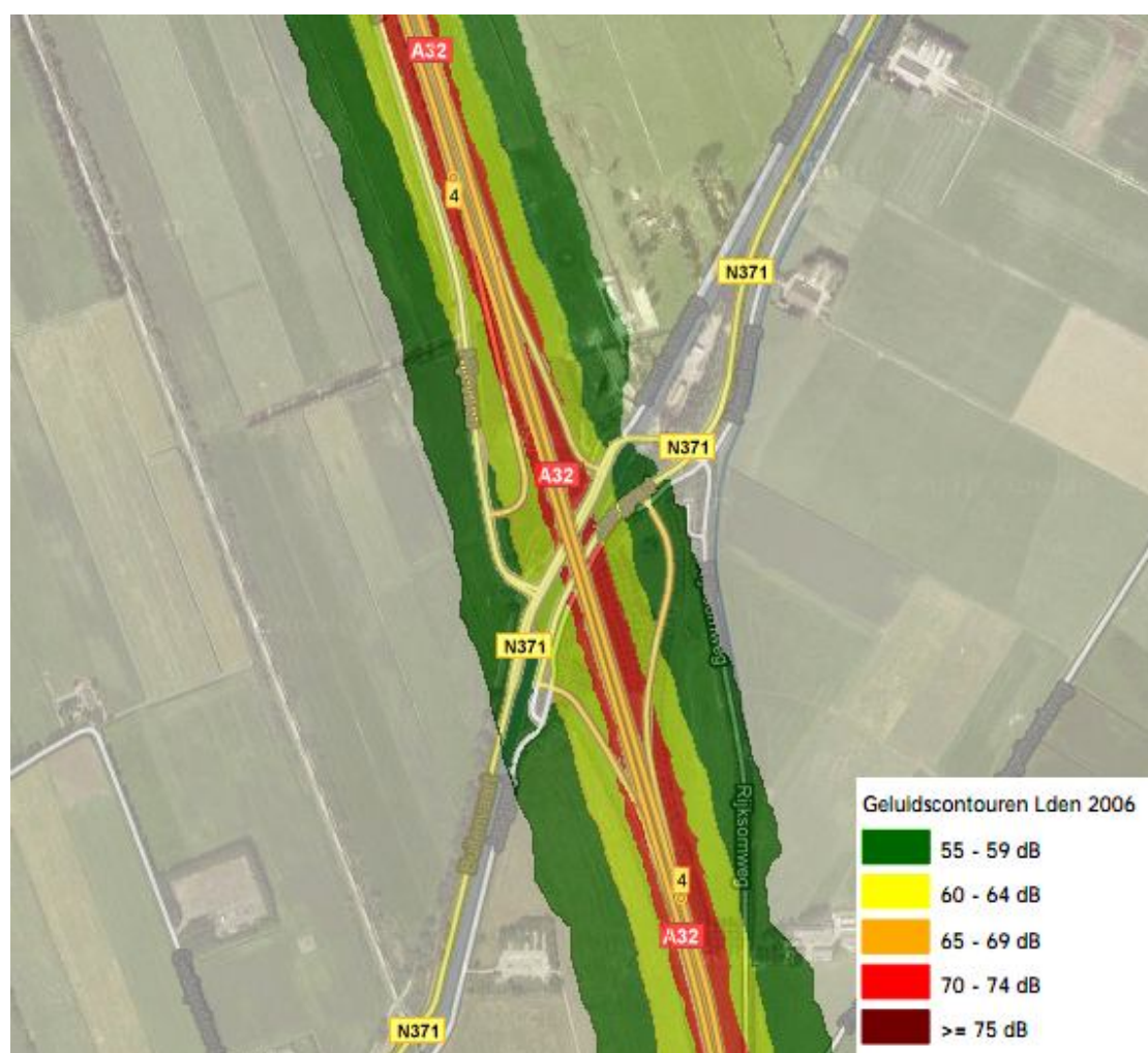
Figuur 32: Geluidsbelasting A32 (Rijkswaterstaat, 2007c)
