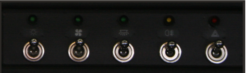
FIGUUR 8.3.2 GEBRUIKTE SWITCHES MIDDENPANEEL
