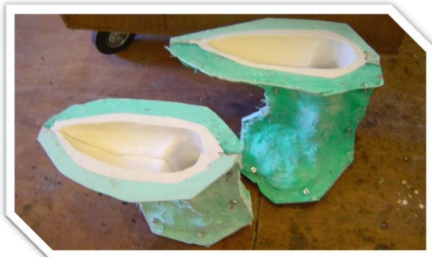
FIGUUR 25: TWEE SILICONEN MALLEN, VERSTEVIGD MET EEN GLASVEZEL JASJE. DOOR DE VERSTEVING ZIJN DE MALLEN BETER BRUIKBAAR, LEKKEN ZE NIET EN WORDEN ZE PRECIJS GOED OP ELKAAR GEDRUKT. DEZE METHODE WORDT TOEGEPAST BIJ GECompliceerde VORMEN VAN OBJECTEN.
