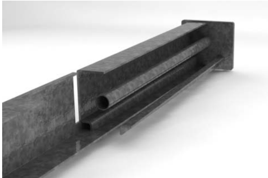
Figuur 6.10 Versteving in onderste gedeelte van het steunprofiel
