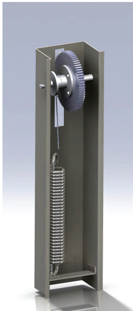
Afbeelding 34 - Plaatsing mechaniek in verbindingsdeel
