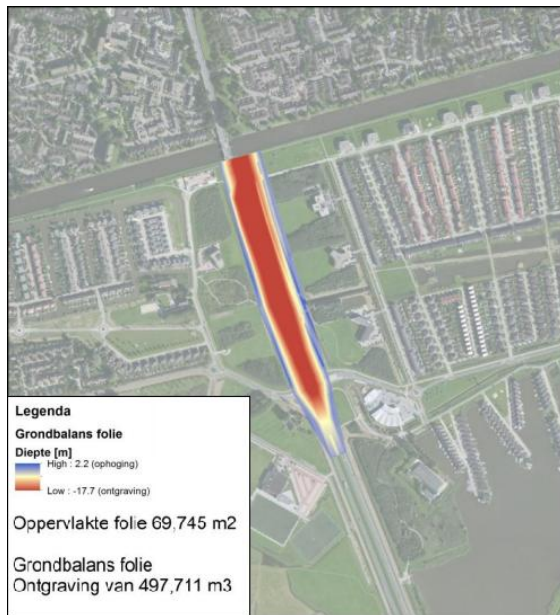
Figuur 10: Bepalen van de grondbalans in GIS met het 3D model, een deel van de grondbalans is weergegeven
