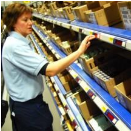
Figuur 12 Een picker aan het werk met een pick-to-light systeem [17]
