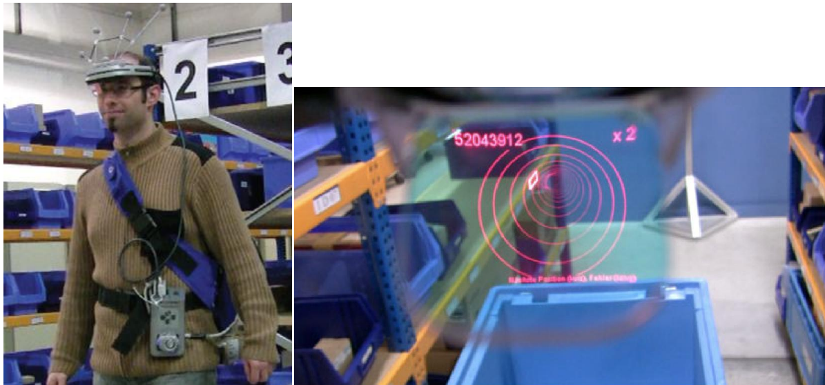
Figuur 10 (links) Een picker uitgerust met een pick-by-vision systeem [13]
