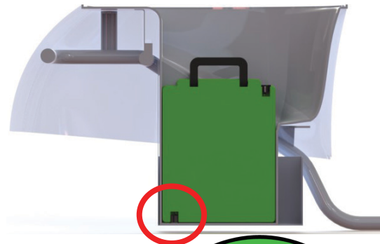
Fig. 79, het oplaadpunt van de accu bevindt zich aan de onderkant van de accu.
