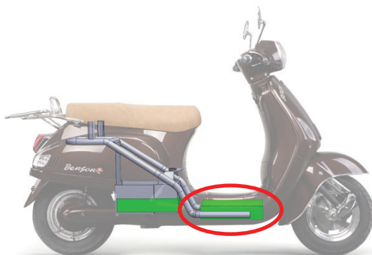
Fig. 43, De omcirkelde accu bevindt zich onder de voetensteun.
