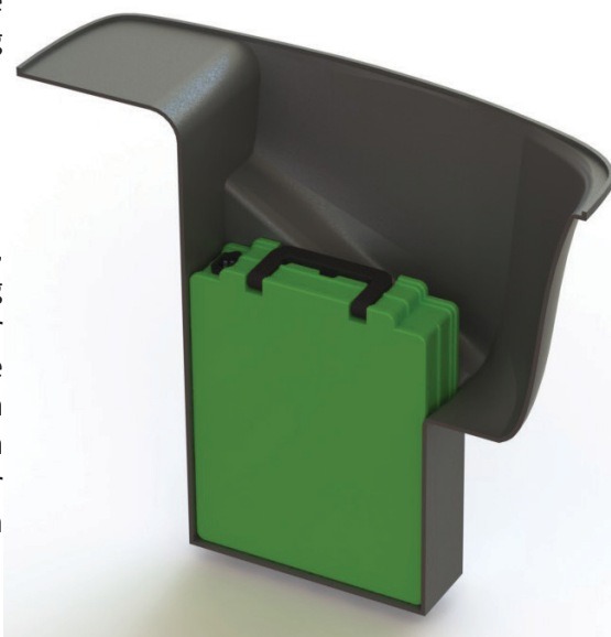
Fig. 69, een doorsnede van de accubak. Hierin is te zien dat er voor de accu nog ruimte voor opslag is. De accu's zijn als 'groen hart' zichtbaar.
