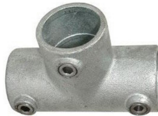
Voorbeeld van een koppelings deel uit de steigerbouw, de inbus bouten drukken tegen de buis aan die erin geschoven wordt.
