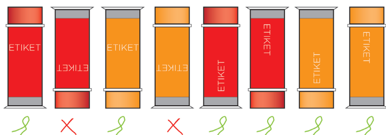
Figuur 86. Richting van het etiket afhankelijk van de configuratie
