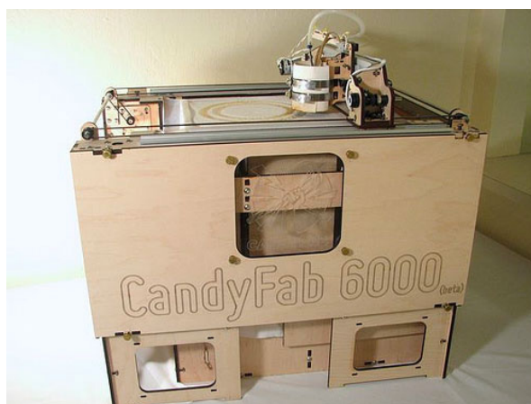
Figuur 42. De Candyfab printer en twee modellen die ermee gemaakt zijn
