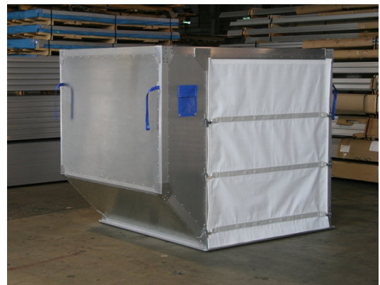
Afbeelding 4. Een standaard Lower-deck ULD-container
