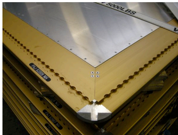
Afbeelding 3. Een aluminium luchtvaart pallet met seat track
