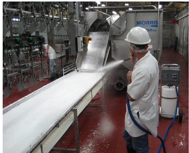
Figuur 4 reinigen van lopende band
