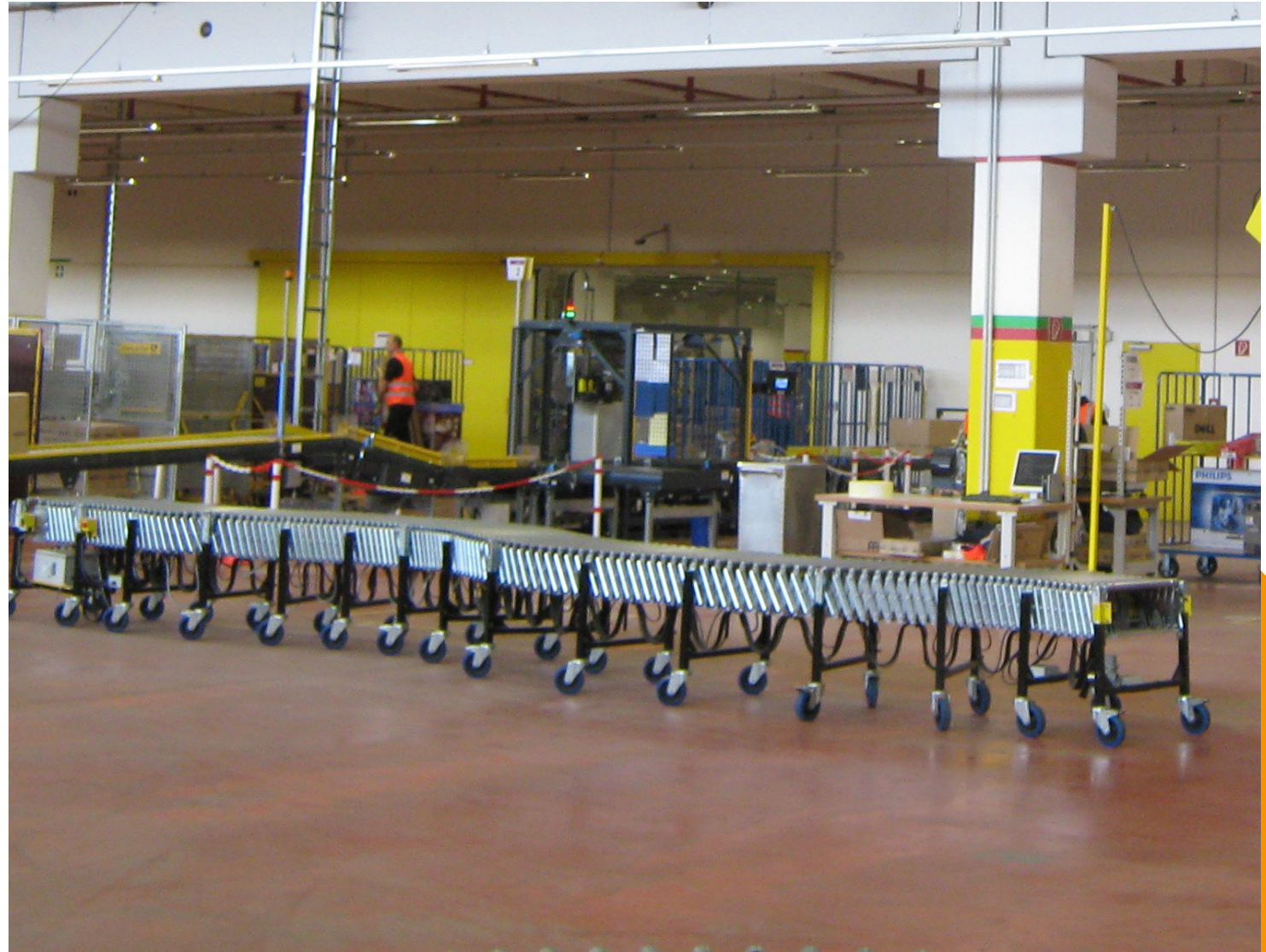
Figuur 6.10 Rijdende harmonica conveyor waar de arm van concept 3 op gebaseerd kan worden.
