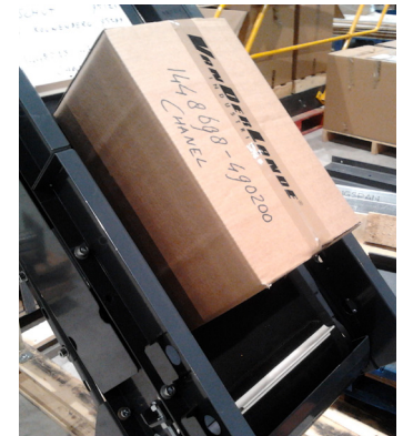
Figuur 7.4 Dit is een test opstelling om banden met een hoge grip te testen. In deze testopstelling blijven de pakketten zelfs op een helling van 45^\circ liggen.
