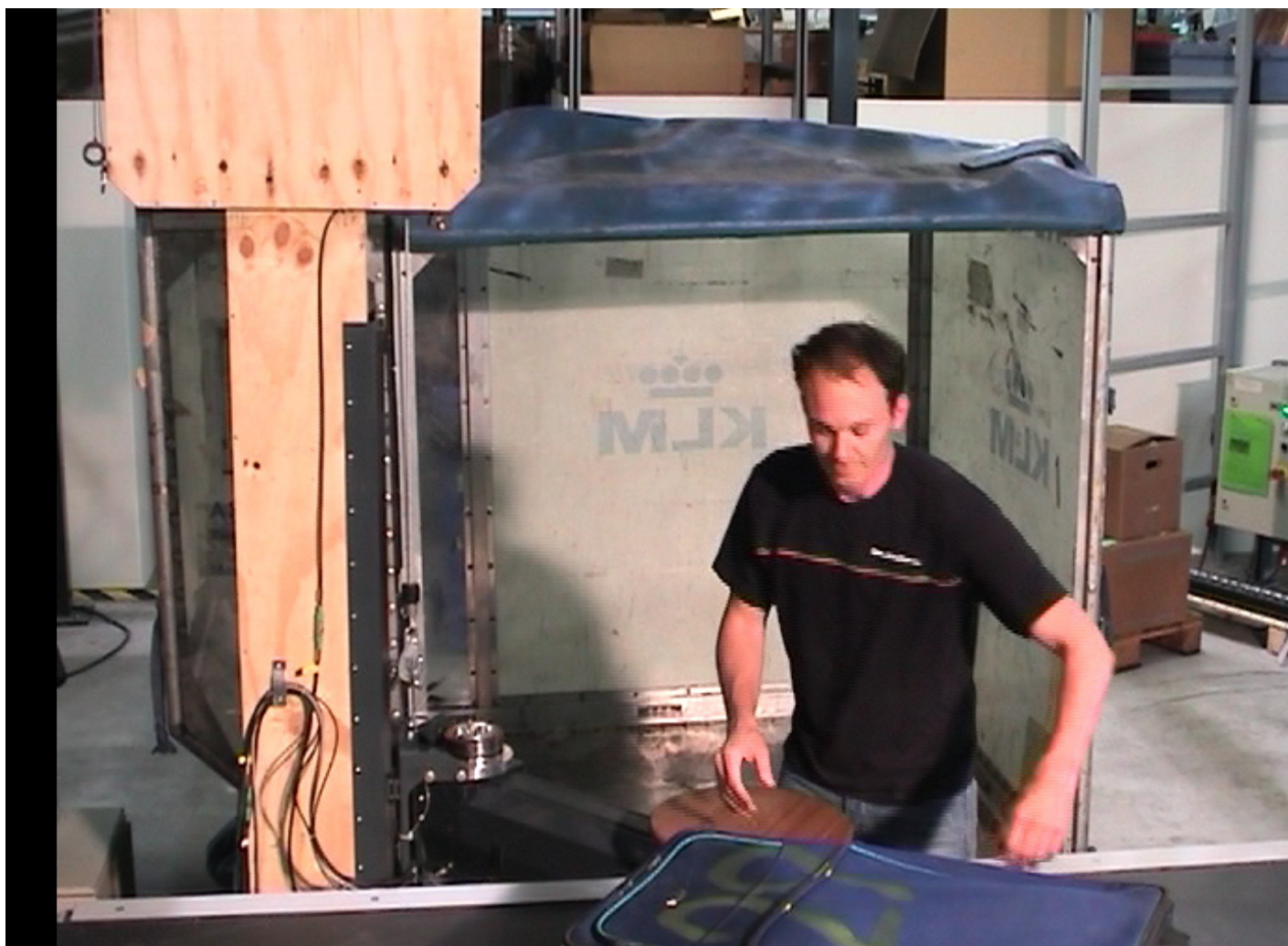
Figuur 3.6 De concepttest van het nieuwe product de BagXup van Vanderlande Industries. Hier testen ze hoe het laden van koffers in de ULD doormiddel van de BagXup verloopt.
