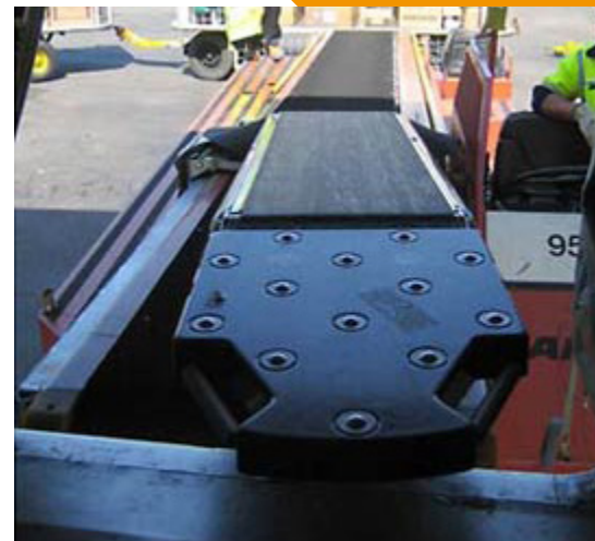
Figuur 3.4 De RTT longreach een semiautomatisch loshulpmiddel voor het lossen van koffers.
