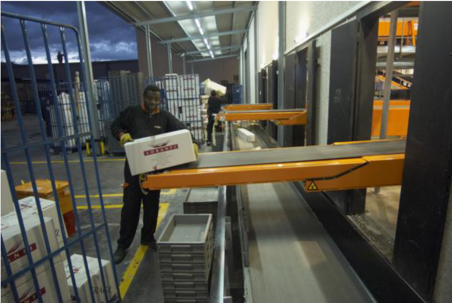
Figuur 2.1 Het lossen naar de belt extendable vanuit rolcontainers bij een postdepot van Enviaia.
