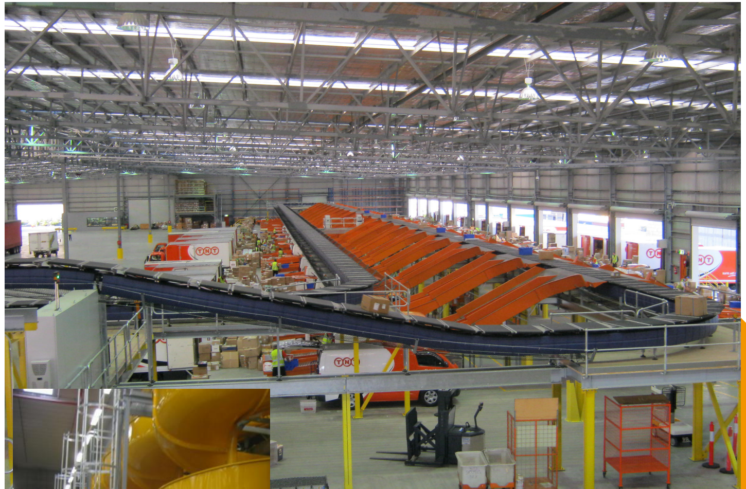
Boven figuur 1.16 Rechts zijn de uitvoerchutes van een TNT postdepot, aan de linker kan worden de pakketten in busjes geladen en aan de rechterkant in vrachtwagen opleggers die aan de dockdeuren worden gezet. Links figuur 1.17 Een operator die pakketten inlaadt. Midden figuur 1.18 Spiraalvormige chutes bij een DHL postdepot.
