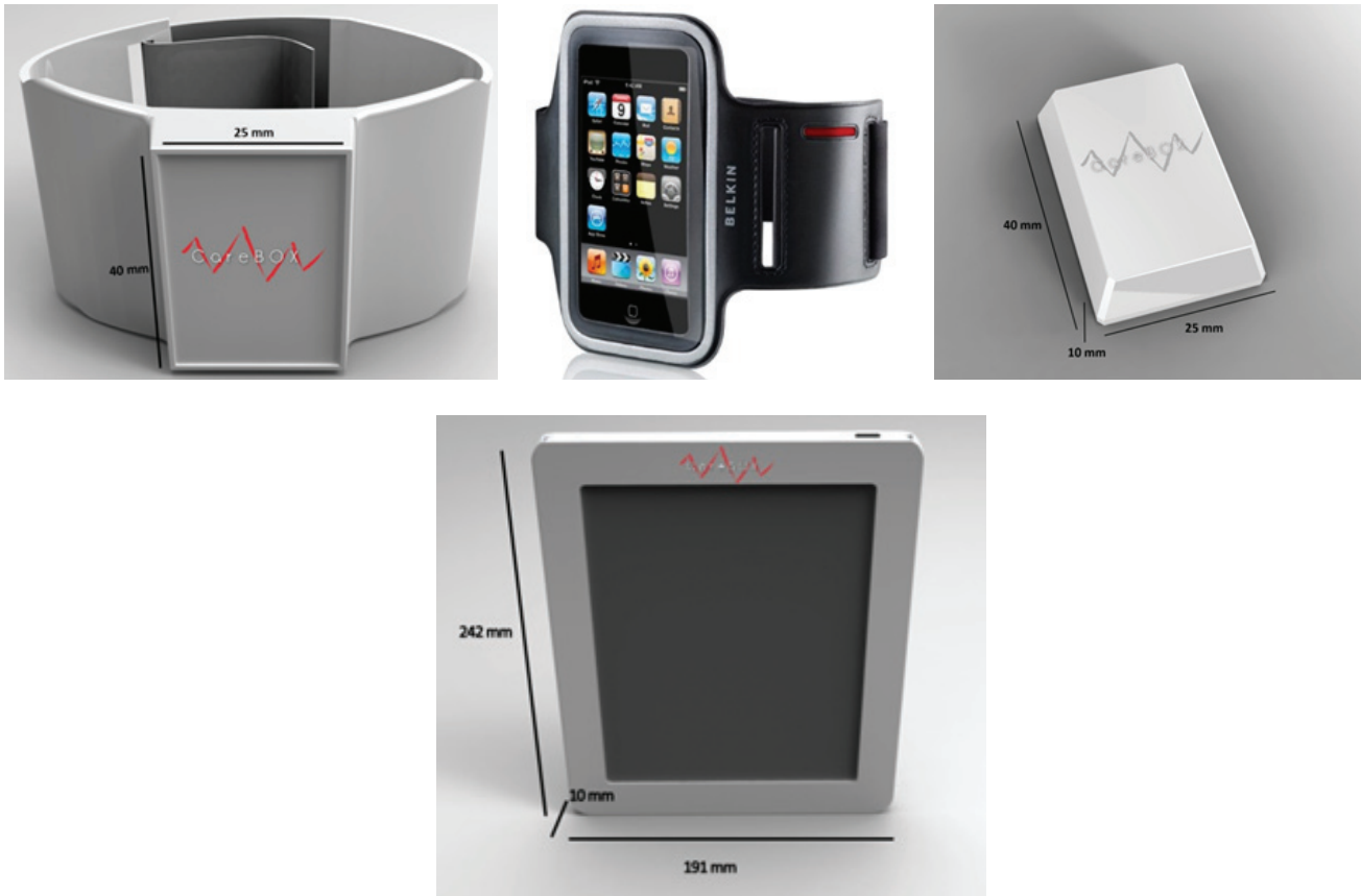
Figuur 22: Bemating van de onderdelen van Concept 1
