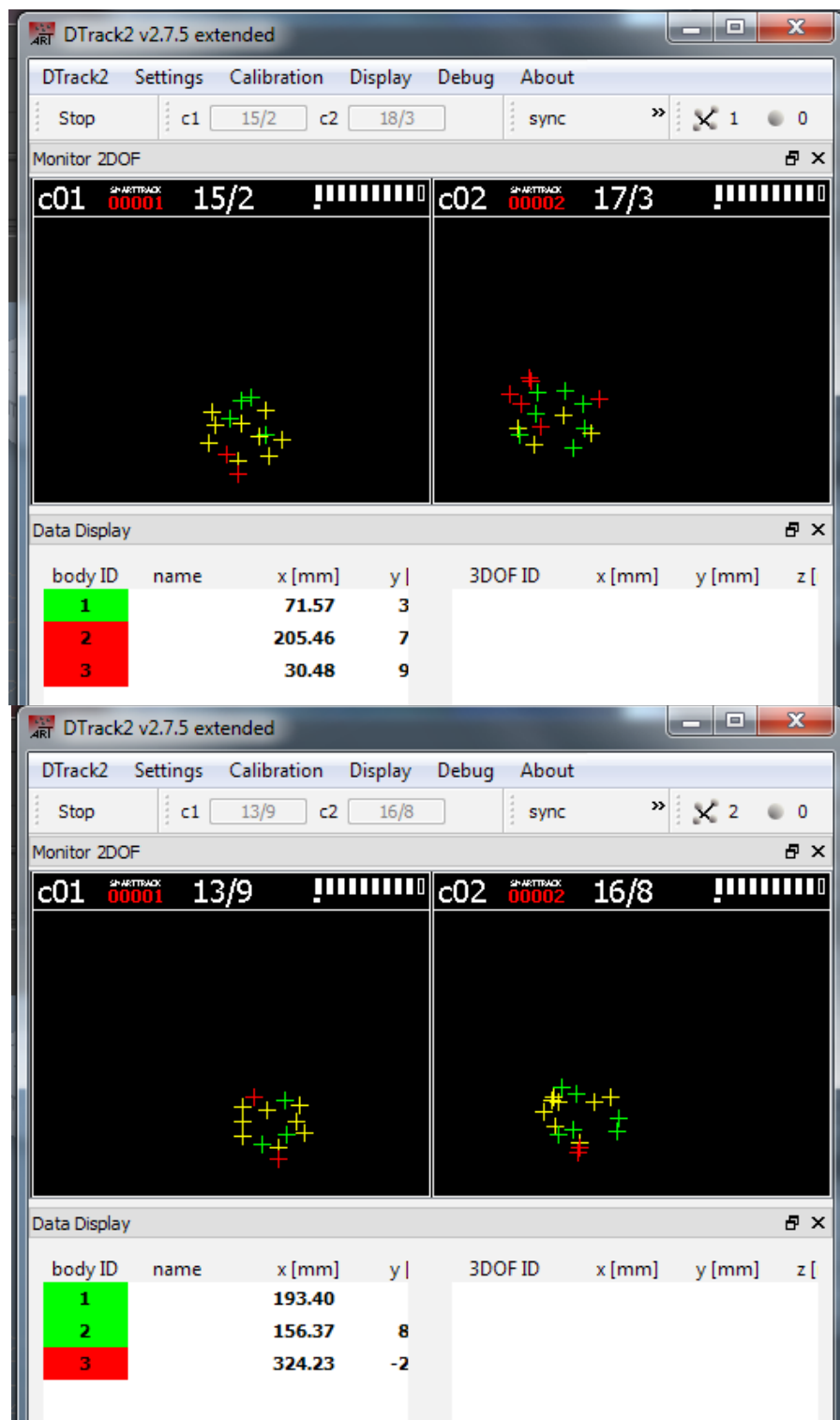
Figuur 23: De DTrack2 interface waar te zien is dat maar één (boven) of twee (onder) van de bodies getracked wordt.
