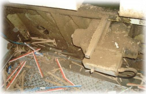
Afbeelding 7: Stof en afval in de machine
