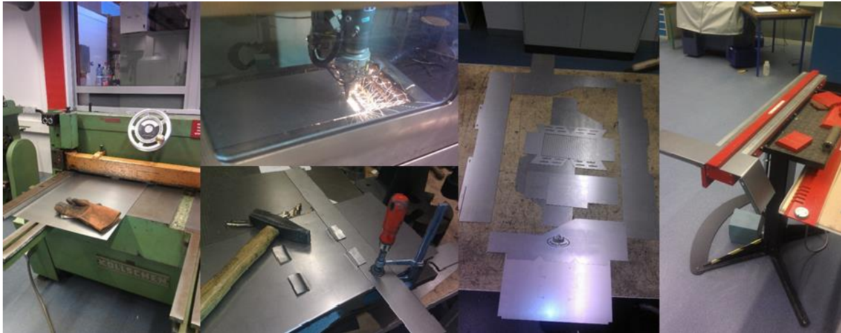
Figuur 90. Fabricageproces van het schaalmodel
